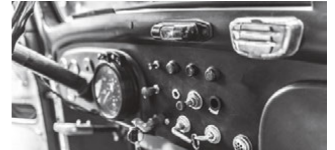
▲ Technik aus der Zeit des Wirtschaftswunders – das Innenleben des L 311 von Mercedes-Benz. Der 6-Zylinder-Hauber ist einer der LKW mit denen Hugo Wiedmann nach dem Zweiten Weltkrieg sein Unternehmen wieder aufbaut. Nicht alle beherrschen dabei auf Anhieb das Spiel mit Vorglühen und Zwischengas. Gelegentlich hört Wiedmann von seinem Büro aus ein lautes Knirschen, wenn beim Gangwechsel Zahnrad und Antriebswelle nicht sauber ineinander greifen.
