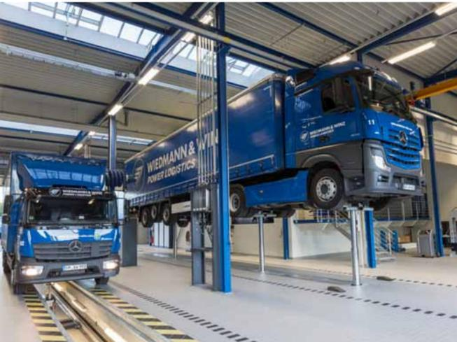
▶ **DIE HAT POWER:** Einen kompletten Sattelzug stemmt die Hebeanlage auf 1,90 Meter Höhe. Die Gruben sind lang genug für mehrere Fahrzeuge.
