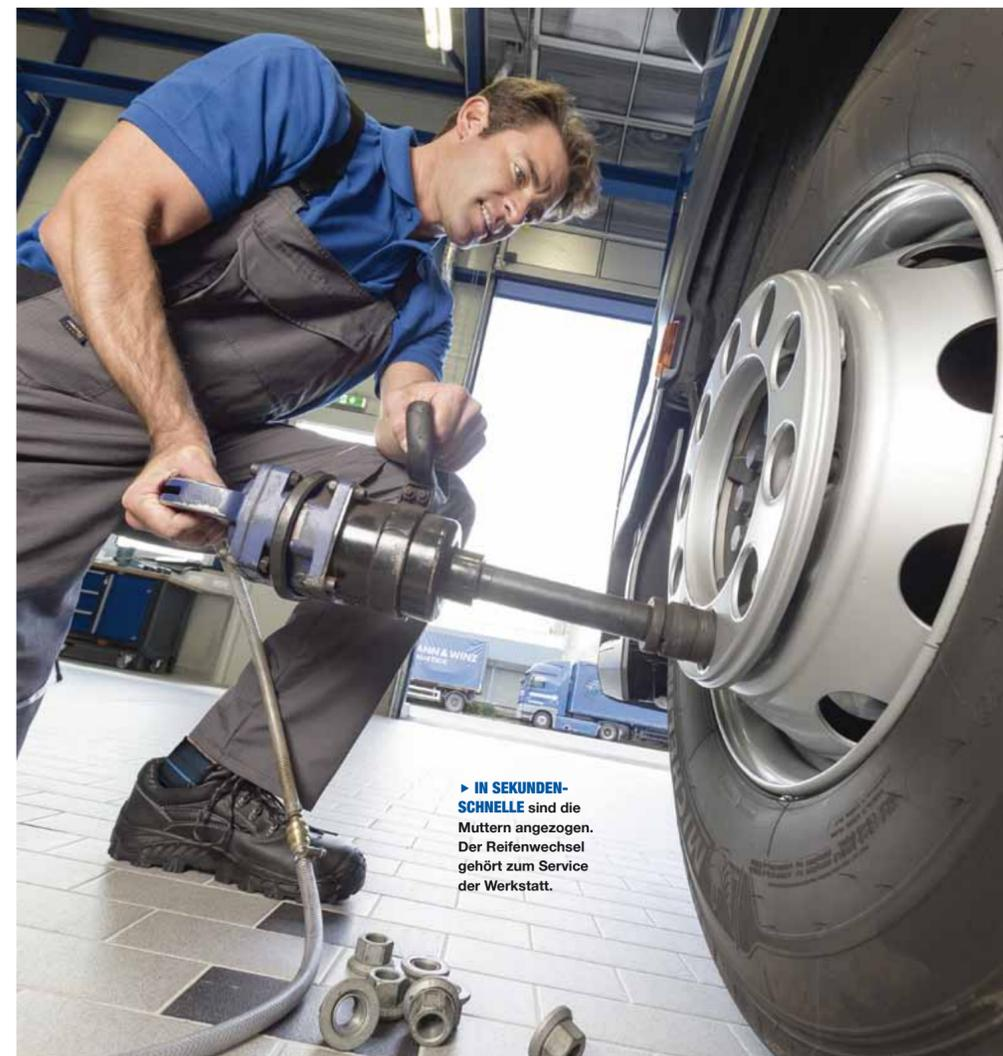
▶ **IN SEKUNDEN-SCHNELLE** sind die Muttern angezogen. Der Reifenwechsel gehört zum Service der Werkstatt.
